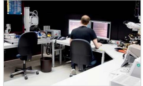
Hochdynamische optische Testeinrichtungen mit leistungsfähiger elektrischer Messtechnik und computergestützter Auswertung für semi- und vollautomatische Beleuchtungsmessungen.
