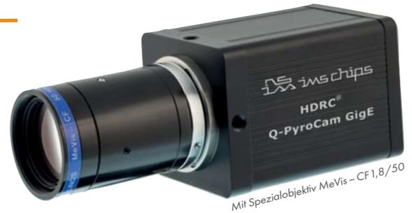
Die Q-PyroCam GigE zeigt die Temperaturverteilung einer Szene an, gleichzeitig ein parallaxenfreies Grauwertbild. Zur Anpassung an die geometrischen Verhältnisse des Messaufbaus können Objektive mehrerer Brennweiten (25, 50 und 75 mm) bei unterschiedlichen Lichtstärken eingesetzt werden. Der bi-spektrale Bildsensor (640 x 480 Pixel) verarbeitet die Strahldichten analog einem Strahldichte-Verhältnis-Pyrometer und kompensiert dadurch die Emissionsgrad-Verteilung in der Szene.
