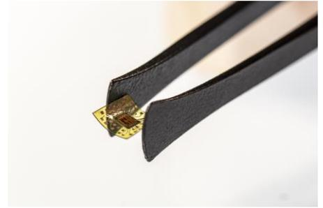
In einem Kooperationsprojekt zur Entwicklung komplexer Foliensysteme [2,3] wurde am Beispiel von Biege- und Stress-Sensorsystemen für einen bionischen Greiffinger nachgewiesen, dass die CFP-Technologie auch mit Druckverfahren und organischer Elektronik kompatibel ist und funktionsfähige Sensorsysteme hergestellt werden können. In Kooperation mit der Universität Stuttgart konnten Foliensysteme für die drahtlose Kommunikation im Frequenzbereich 5 GHz hergestellt werden [4].
