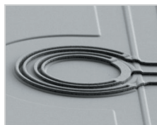
Aktives Bauelement in der Silizium Photonik: Ringresonator
