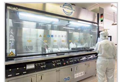
Neue Edelstahlanlage zur Prozessierung von Produkten mittels organischer Lösungsmittel
