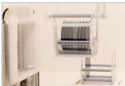
Gleichzeitige automatische Prozessierung von 150 mm und 200 mm Substraten
