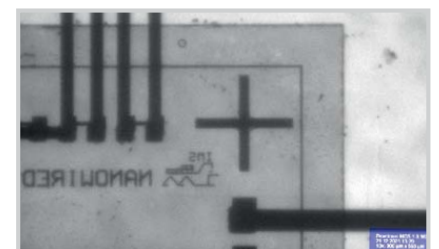
Abb. 3 Infrarotaufnahme eines gefügten hybriden Foliensystems mit Nanokontakten
